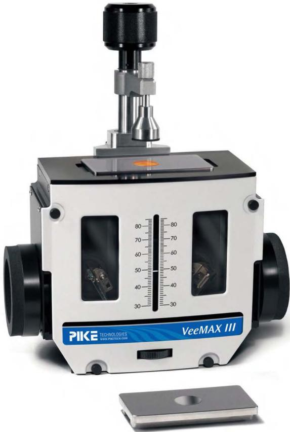
簡単に ATR 結晶への入射角度を可変できることで深さ方向の ATR 測定ができる、他に入射角度を大きく設定可能なため、表面分析 (単分子膜測定など)にも利用できます。入射角度の決定にも最適です。
