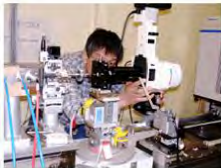
加熱ステージと組み合わせて微小試料のラマンスペクトルを測定
