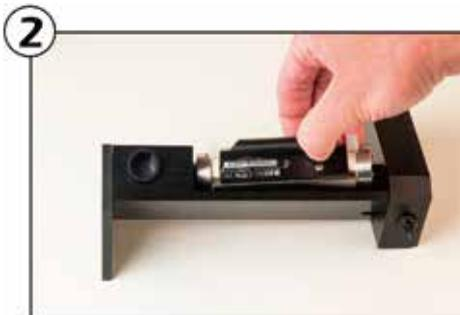
**Fill Station™**へ40Tセルを置きます。測定セル背面が手前となります。
