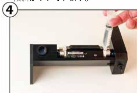
40Tセル右側（傾斜の低い方）よりゆっくり試料溶液を注入します。
