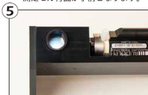
下図のように確認窓は試料充填を始めると暗くなります。気泡がなく、きれいに充填が行えると明るく、はっきりと光を確認することができます。
